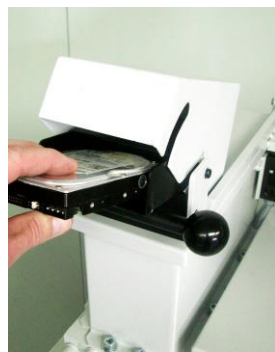
Sondertrichter zur manuellen Aufgabe der Festplatten
